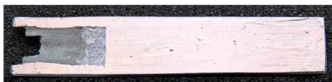
Bild 6: Auf der Unterseite der Platine ist der Eingangsbereich ohne Massefläche ausgeführt.
