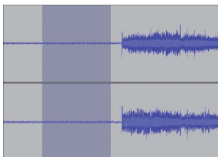
Bild 5: Bereits die Reibung der sensiblen Ton-nadel in der Rille des Vinyls erzeugt ein Rauschen, das Audacity mittels Filter entfernt.
