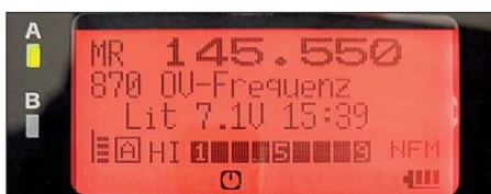
Anzeige eines Bandes mit Speicherkanalnamen, Betriebsspannung und Uhrzeit
