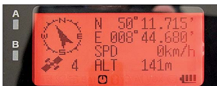
Das eingebaute GPS-Modul liefert Position, Geschwindigkeit und Richtung.
