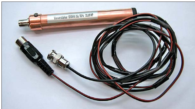
Bild 1: Ansicht des Verstärkertastkopfs im Gehäuse mit der Spannungszuleitung und dem Koaxialkabel für das Ausgangssignal
