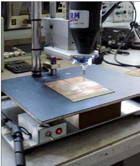
Bild 1: Ansicht der selbst gebauten Ständerbohrmaschine auf dem Arbeitstisch; Zwischen der Grundplatte und der Arbeitsplatte lassen sich unter anderem die Spannungsversorgung für die vier LEDs zur Beleuchtung an der Einspannklemme und auf der entgegengesetzten Seite die passenden Bohrer unterbringen. Fotos: DK4DDS
