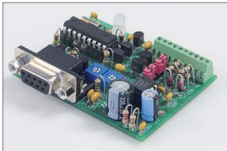
Bild 1: Der aufgebaute ID-O-Matic II; die wenigen Bauelemente finden auf einer nur 64 mm x 50 mm großen Platine Platz.
