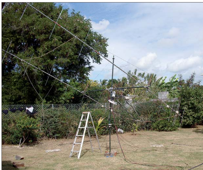
Die Antennen für 144 MHz: 2 x 10-Element-Kreuz-Yagi-Antennen nach DJ9BV-Design; bei manueller Azimut- und Elevationsrotation
