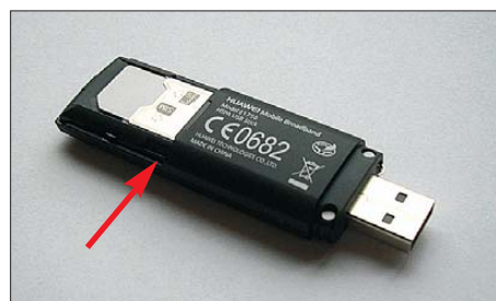
Bild 11: Einige UMTS-Sticks besitzen eine (von außen nicht erreichbare) externe Anschlussbuchse, die erst nach dem vorsichtigen Öffnen des Gehäuses sichtbar wird. Nach dem Öffnen markiert man sich die Position und bohrt an dieser Stelle ein Loch in das Gehäuse. Und die externe Antenne passt...
