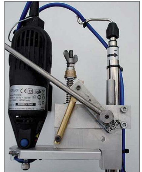
Bild 2: Seitenansicht des Spindelkopfs mit dem Betätigungshebel
