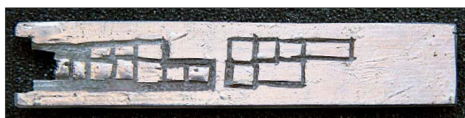
Bild 5: Oberseite der von Hand gefrästen Platine des Tastkopfs
