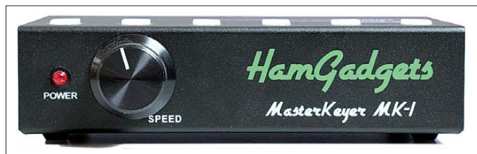
Bild 1: Der MasterKeyer MK-1 mit den sechs beleuchteten Multifunktions-tasten auf der Oberseite des Gehäuses.
